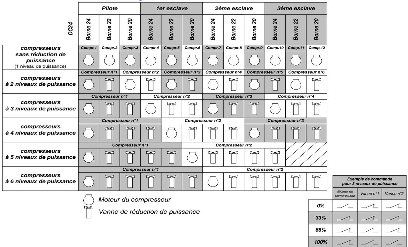
La procédure de régulation est similaire. La seule différence apparaît dans le choix des sorties "tout ou rien" lors d'incrémentation ou de décrémentation de puissance. Si la puissance doit être augmentée, l'appareil préférera ajouter un cylindre du compresseur qui est déjà enclenché, plutôt que d'enclencher un compresseur supplémentaire.
