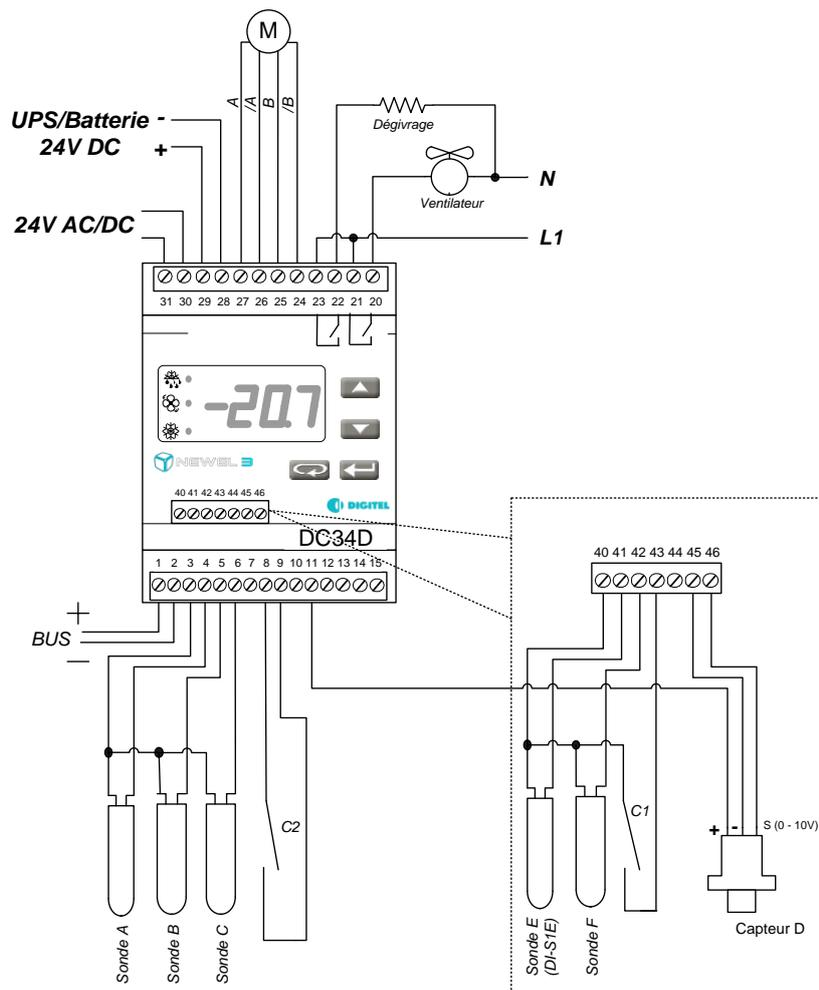
Il est important de vérifier que l'alimentation principale aux borniers 30-31 et l'alimentation UPS/batterie aux borniers 28-29 sont bien connectées. Si seule l'alimentation principale est connectée, en cas de panne de courant, le régulateur ne pourra pas fermer le détendeur. Si, par contre, seule l'alimentation UPS/batterie est connectée, le régulateur agira comme s'il y avait une coupure de courant et maintiendra le détendeur complètement fermé.
