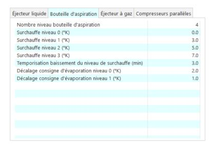
La bouteille d'aspiration joue un rôle crucial non seulement en déterminant l'éjecteur à activer mais également en ajustant les paramètres du système de réfrigération :
