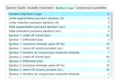
Semblables aux éjecteurs liquide, les éjecteurs gaz sont activés par la haute pression et l'ouverture de la vanne haute pression. Cependant, leur mécanisme de régulation de puissance diffère légèrement :
